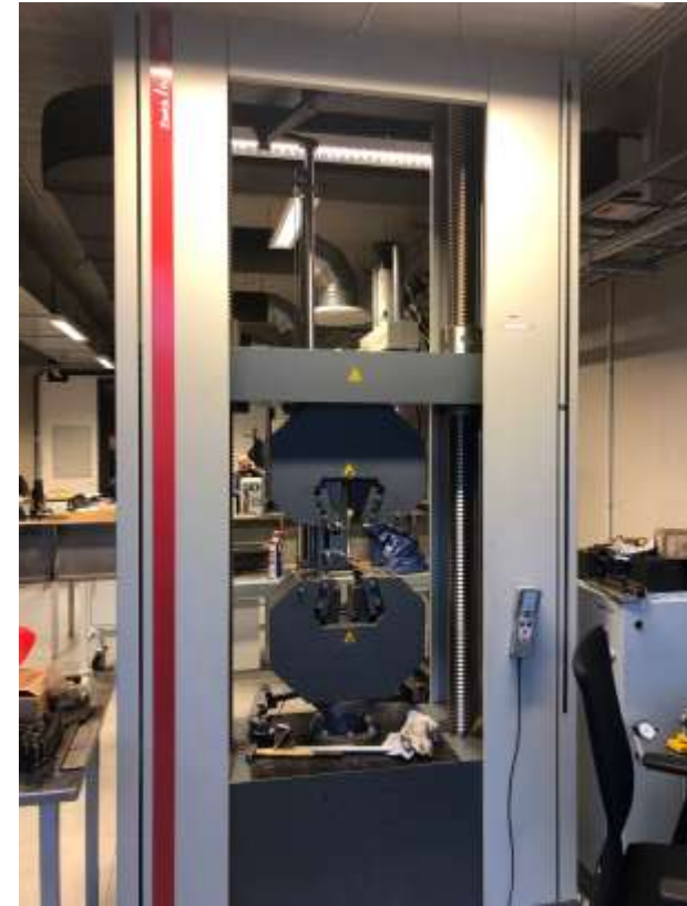
Zwick/Roell Z600 Elektro-mehāniskā slogošanas iekārta Režīms: statiskā slodze, stiepe/spiede Slodzes kapacitāte: \pm 600 kN
