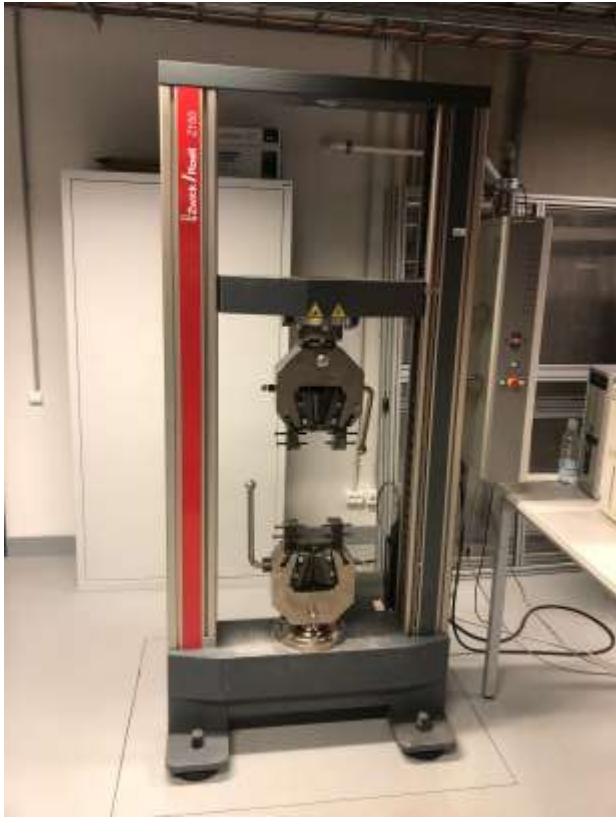
Zwick/Roell Z150 Elektro-mehāniskā slogošanas iekārta Režīms: statiskā slodze, stiepe/spiede Slodzes kapacitāte: \pm 150 kN
