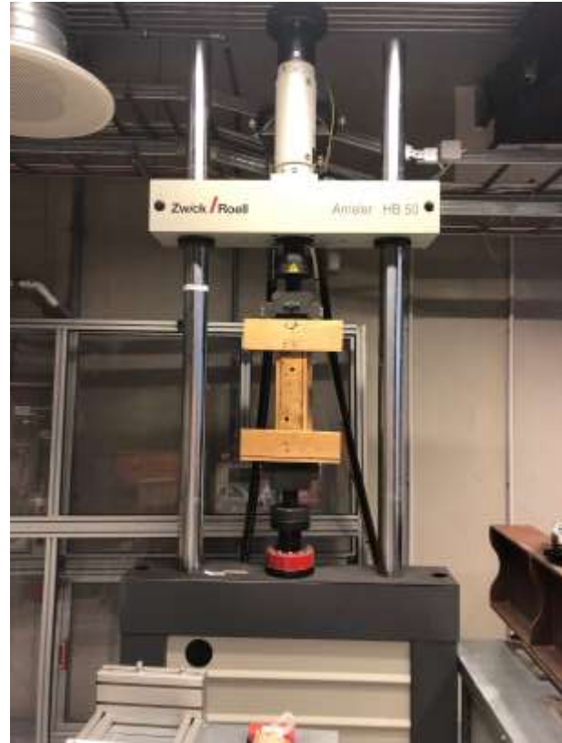
Zwick/Roell Amsler HB50 Hidrauliskā slogošanas iekārta Darbības režīms: dinamiskā (cikliskā) un statiskā slodze, stiepe/spiede Slodzes kapacitāte: \pm 50 kN
