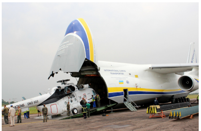
3.58. attēls. Kravas iekraušana no aizmugures, izmantojot lidmašīnas celtni (pa kreisi), un kravas "ieripināšana" lidmašīnā caur paceltu priekšgalu (pa labi)
