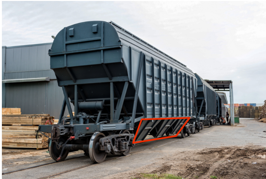
3.24. attēls. Hopera vagon (ar sarkanu apvilktas tā izkraušanas lūkas)
