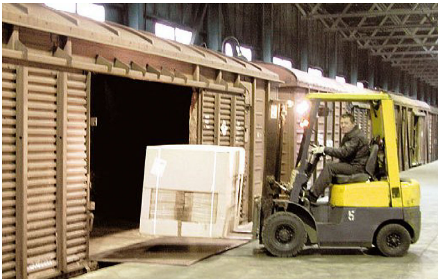
3.33. attēls. Slēgtā vagona izkraušana, ja tā grīda ir vienā līmenī ar noliktavas rampu
