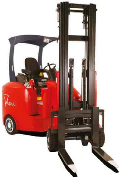
2.21. attēls. Šauru eju iekrāvējs Flexi VNA (pa kreisi), paaugstinātas caurejamības iekrāvējs Ausa (pa labi)
