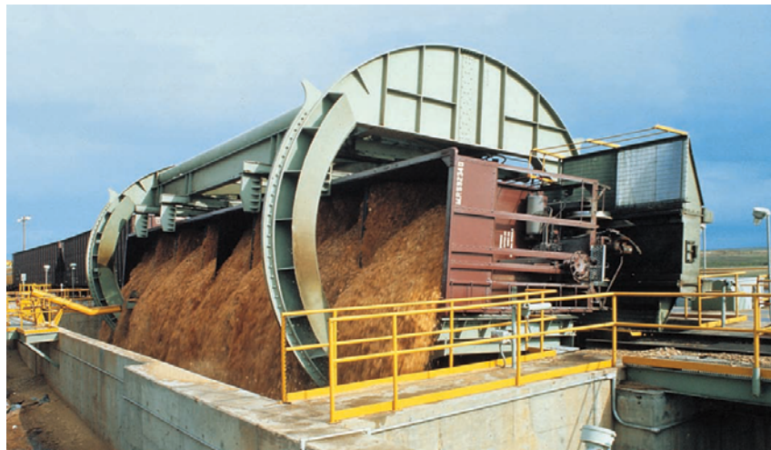
3.25. attēls. Pusvagona izkraušana, to apgāžot
