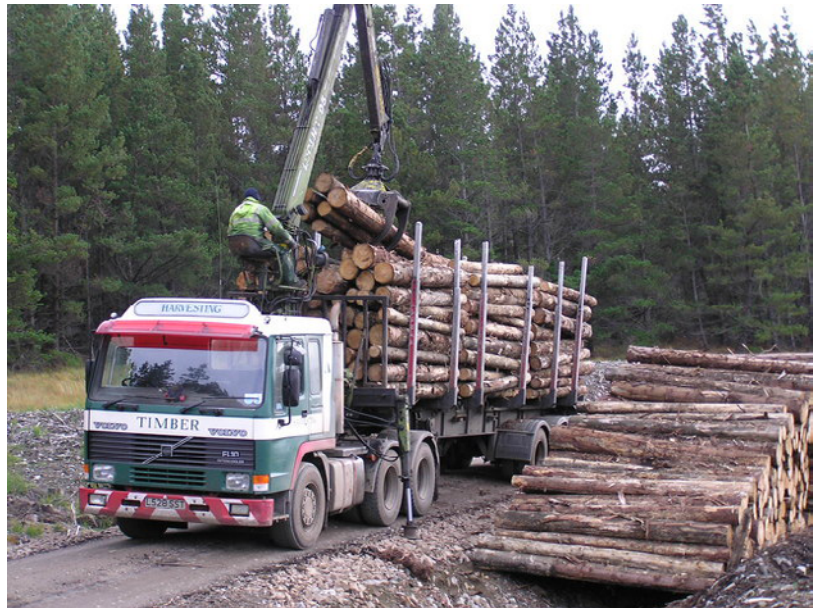
2.27. attēls. Baļķvedējs ar manipulatoru
