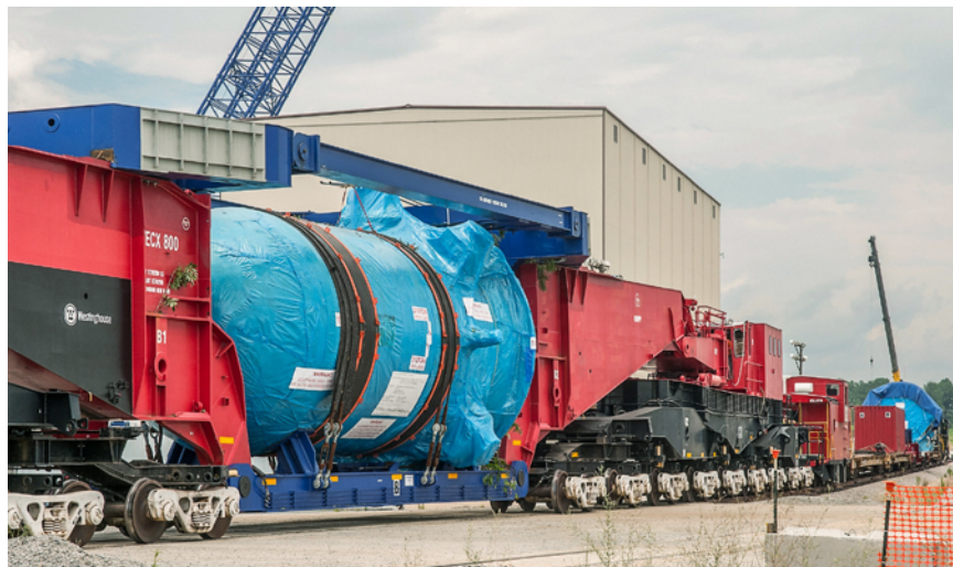
3.29. attēls. Lielgabarīta kravas pārvadājums, izmantojot dzelzceļa transportiera vagonu
