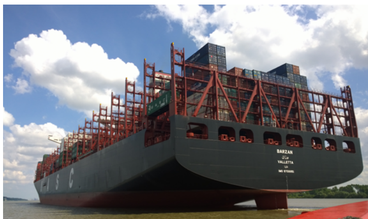
3.44. attēls. Konteineru kuģis ar aizmugurē redzamām konteineru stiprināšanas sistēmām
