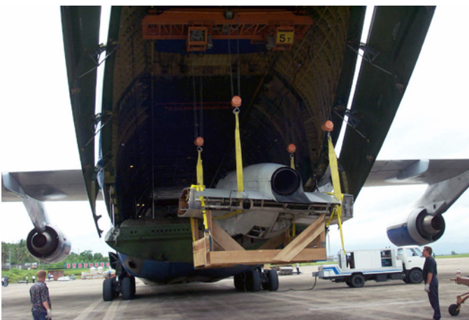
3.58. attēls. Kravas iekraušana no aizmugures, izmantojot lidmašīnas celtni (pa kreisi), un kravas "ieripināšana" lidmašīnā caur paceltu priekšgalu (pa labi)
