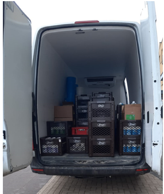
3.13. attēls. Skats pa atvērtām aizmugures durvīm autotransporta vienībai ar saldētavu
