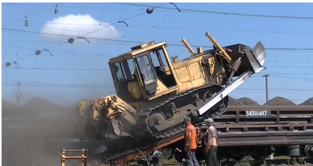
3.34. attēls. Buldozera iekraušana, tam uzbraucot uz platformas vagona
