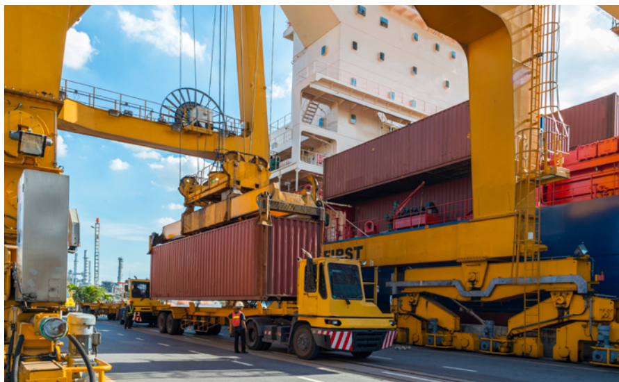
3.9. attēls. Jūras konteineru uzkraušana uz konteineršasijas piekabes ostas terminālī
