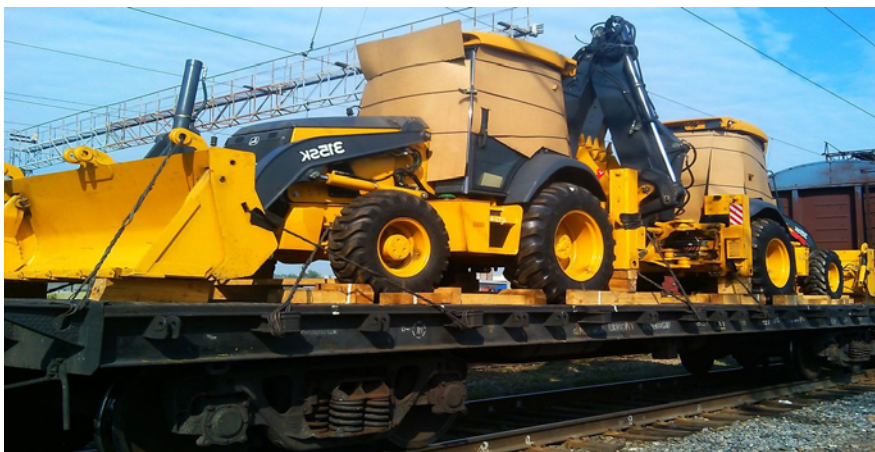
3.30. attēls. 13 300 mm gara universālā platforma ar kravu: diviem ekskavatoriem
