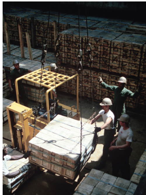
3.5. attēls. Kravu iekraušanas operācija ģenerālkraavu kuģī
