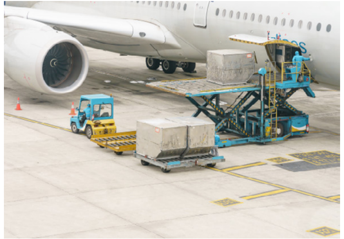
3.57. attēls. Kravas iekraušana lidmašīnā, izmantojot platformu
