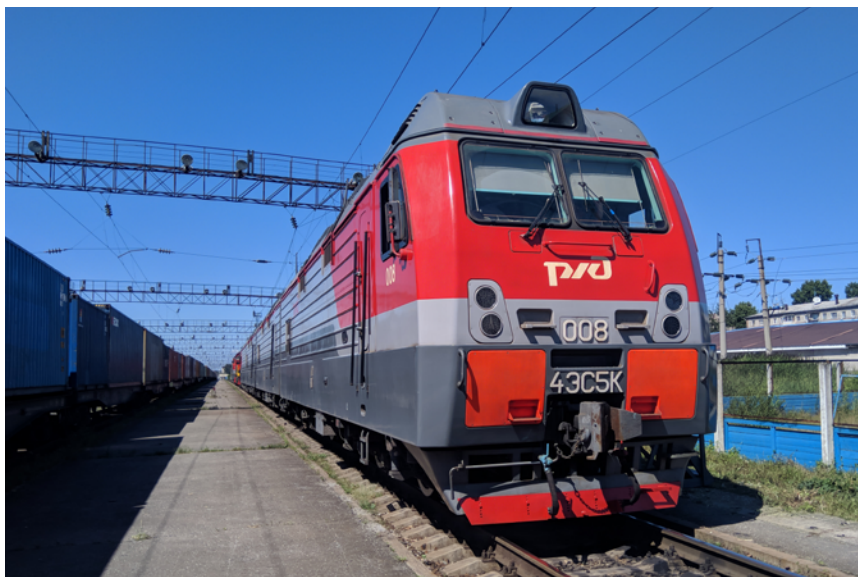
3.21. attēls. Novočerkaskas elektrisko lokomotīvu rūpnīcas ražotā lokomotīve 4ES5K (2018. gadā tā bija lokomotīve ar pasaulē vislielāko jaudu – 17 838 zirgspēki)
