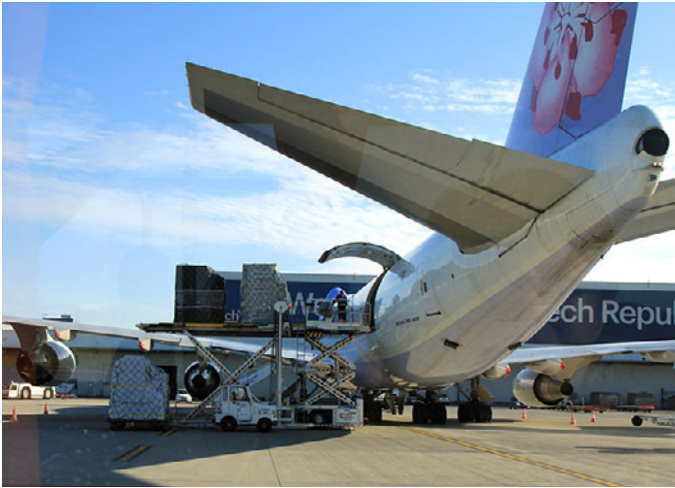
3.57. attēls. Kravas iekraušana lidmašīnā, izmantojot platformu
