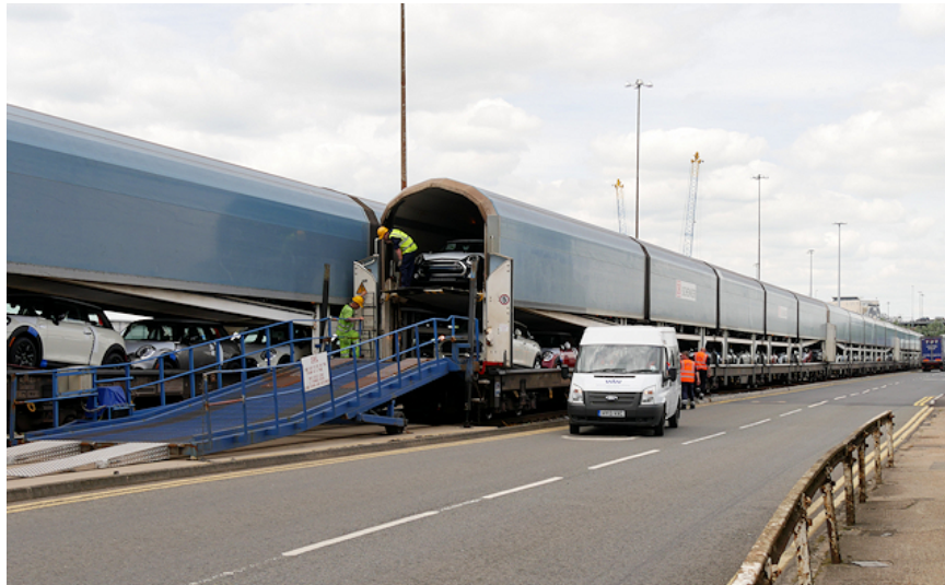
3.28. attēls. Vieglo automobiļu izkraušana no divstāvu auto vagona
