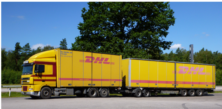
3.15. attēls. Vācijā lietotie palielinātā garuma treileri ( Gigaliner, Megliner )
