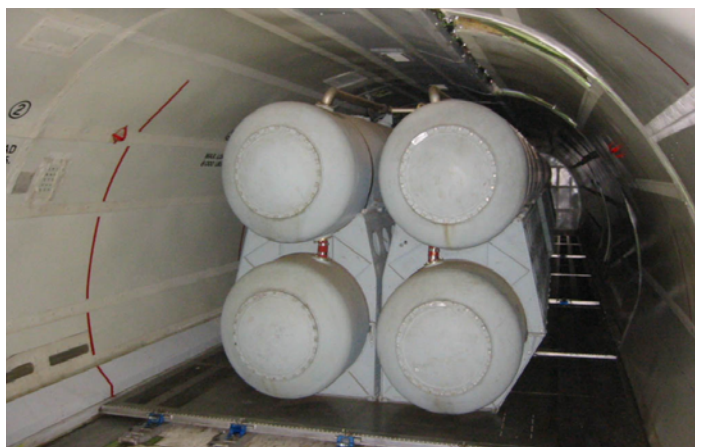
3.59. attēls. Boeing 727-223 (pa kreisi); tā korpusā izveidoti degvielas tanki (pa labi)
