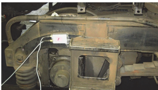
2.8. att. Sensoru stiprinājums uz lokomotīves ratiņu rāmja.
