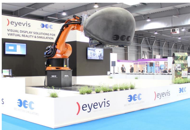
3.attēls. Industriāls robota iekārta KUKA KR 600 R2830 Passenger ar virtuālās realitātes kabīni BEC simulāciju un pētniecības vajadzībām saskaņā ar EN13814 standarta prasībām.
