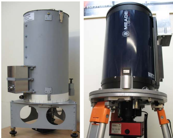
8. att. Digitālās zenītkameras prototips (pa kreisi) un gala konstrukcija (pa labi)
